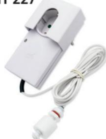
Die Pumpensteuerung SHT 217 mit Geräteeinschaltung wird einfach in die Steckdose gesteckt und dort hinein wird dann Ihre Pumpe eingesteckt. Sie bestimmen den Wasserstand ab dem die Pumpe sofort einschaltet und nach Abfall des Wasserstands das Gerät nach einer einstellbaren Nachlaufzeit (stufenlos einstellbar zwischen 0 und 100 Sekunden) auch wieder ausschaltet.
