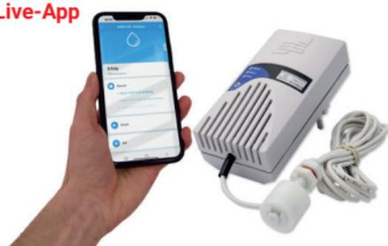
Der **WWD 240** Wassermelder ist ein Plugin-Steckdosengerät, zur Montage das Gerät einfach in eine Steckdose einstecken und den Wassersensor am Boden montieren. Bei Bedarf können Sie die Sensorleitung bis zu 50 m mit einem LIYY-Kabel (max. 2 x 0,14mm<sup>2</sup>) verlängern. Das Kabel sollte nicht parallel zu 230 V Netzkabeln verlegt werden.
