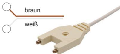
**Wassersensor SHT 5800** mit zwei V4A Edelstahlkontakten, in wasserabweisendes Kunststoffgehäuse vergossen, mit Aluminium verstärkter Mittelbohrung 3,2mm, ideal für Kanten-/Eckenmontage. 10 x 12 x 34 mm
