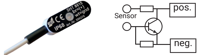
Schaltprinzip „unipolarer Widerstand“
