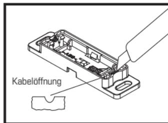
3. Breiten Sie die Öffnung am Gehäusedeckel mit dem Messer vor. Bitte beachten Sie, auf welcher Seite die Öffnung der Oberschale eingeschnitten wird. Dies hängt von der Position des Reed-Kontaktschalters am Fenster ab. Die Kabelöffnung nur so groß schneiden wie nötig, damit das Kabel durch den Gehäusedeckel fixiert wird.
