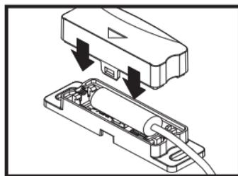
5. Befestigen Sie Magnet und Schalt-
